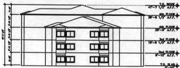
B EXTERIOR ELEVATION 301 ROAD N.T.S.
