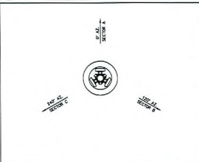
ANTENNAS INSIDE POLE SCALE: 1" = 8'
