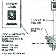
5 ACCESSIBLE PARKING SIGN. Scale: N.T.S.
